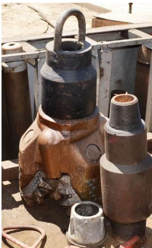
Figura nr. 2-8 Model de sapă cu role, utilizată în procesul tehnologic de foraj, amplasată pe una din localțiile AMROMCO ENERGY
