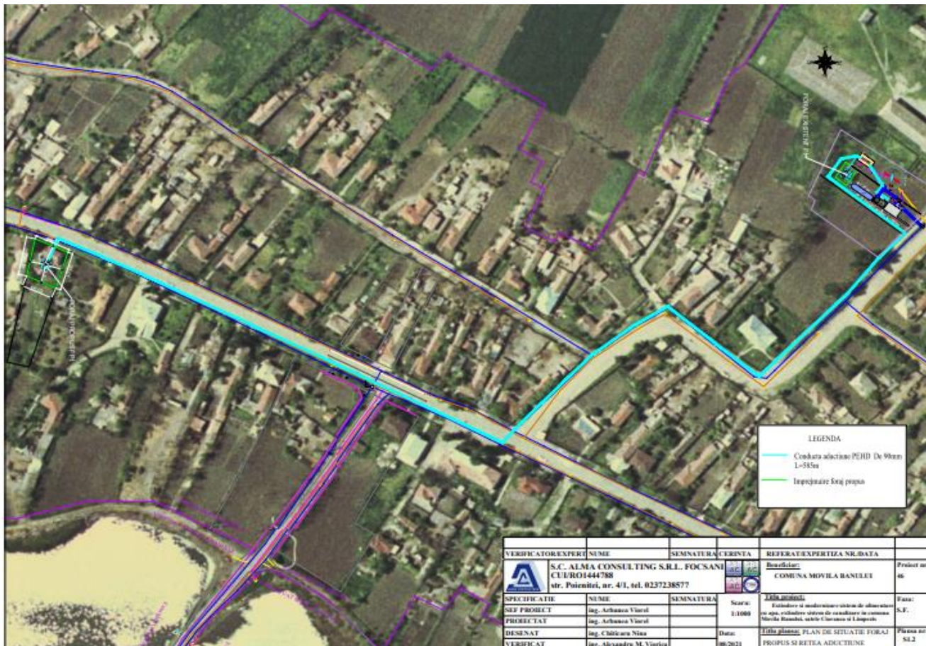
Foraj nou propus și aducțiune (585 m conductă PEHD De 75mm) la GA existentă
