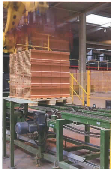
# Bratul robotului asezand caramizile fasonate pentru procesul de uscare
