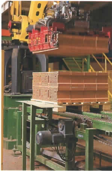
# Bratul robotului asezand caramizile fasonate pentru procesul de uscare
